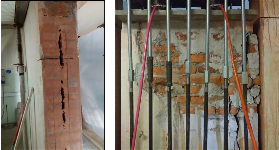
Figura 24: interno della muratura di mattoni pieni e esito delle prove di rottura
